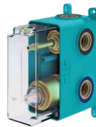
INT9036-00 Scatola ad incasso Handy Box per miscelatore con cartuccia Ø35 e deviatore 2-3 uscite.
